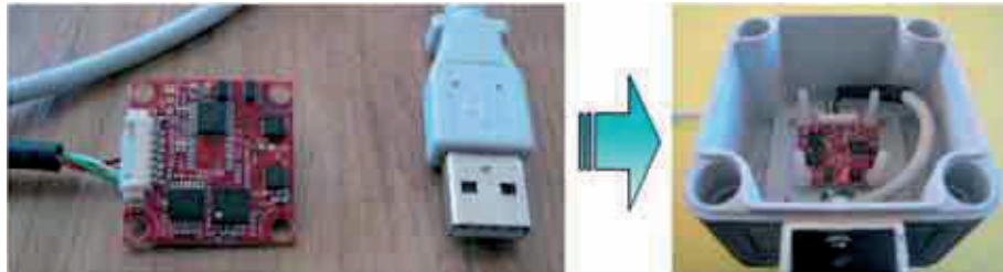
Abbildung 3: Low Cost Kompassmodul mit Beschleunigungs- und Magnetfeldsensor
