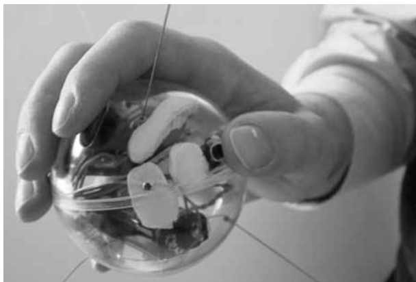
Bild 5 Das SPIDAR: Force-Feedback auch für großräumige VR-Umgebungen.
