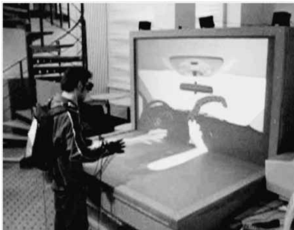
Bild 2 Ein Kooperationsszenario: Benutzer 1 entwirft und testet einen Arbeitsplatz mit Datenhandschuhen an einer Holobench; Benutzer 2 bewertet die Szene zeitgleich an einem anderen Ort.
