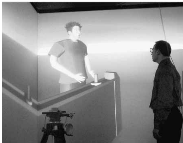
Bild 2 Ein Kooperationsszenario: Benutzer 1 entwirft und testet einen Arbeitsplatz mit Datenhandschuhen an einer Holobench; Benutzer 2 bewertet die Szene zeitgleich an einem anderen Ort.
